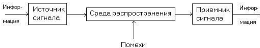
Рисунок 5 - Структурная схема канала утечки
