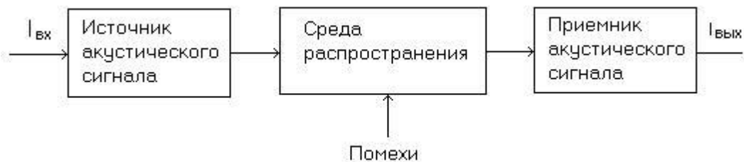
Рисунок 3. Структурная схема канала утечки информации
