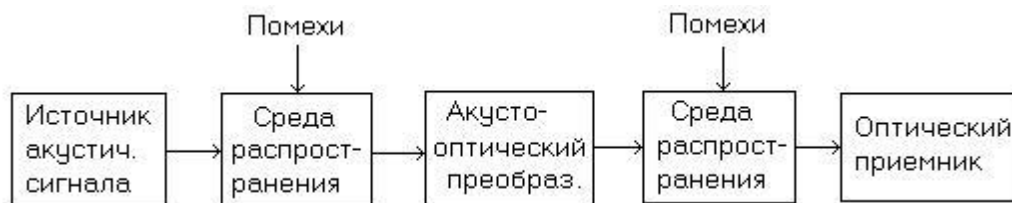
Рисунок 1 - Структурная схема канала утечки информации
